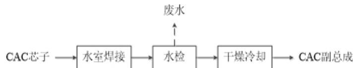
(b) CAC副总成生产工艺及产污流程图
