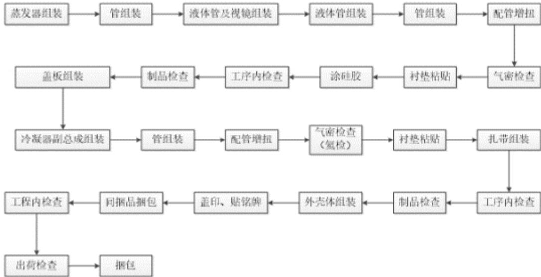
图 3-6 冷冻机生产工艺及产污流程
