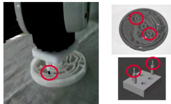
Fig. 5 ランドマーク認識によるバラ積みピッキング 7)
