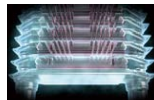
インバータの両面冷却構造
