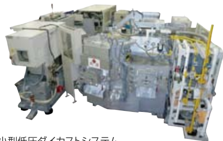
省エネ小型低圧ダイカストシステム (縦6.5m×横5.5m×高さ1.8m)
