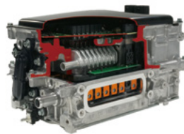
パワーコントロールユニット
