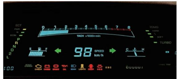
Fig.13 ハーフミラーを用いた立体表示メータ
