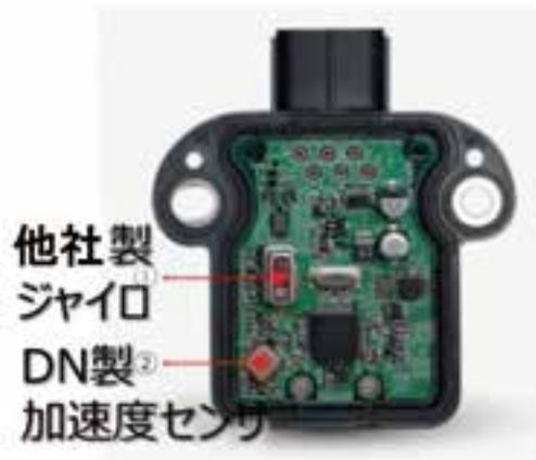
Fig. 13 Inertia Sensor
