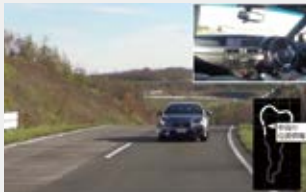
デンソー網走テストセンター内でのカントリー路の自動車走行試験
