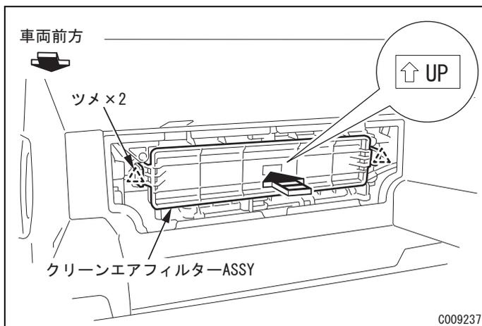
(2) クリーンエアフィルター ASSY（ツメ 2箇所）を取り付ける。
