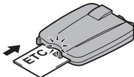
ETC車載器にETCカードを入れて、緑色ランプが点灯していることを確認します。橙色ランプが点灯している場合は、「異常発生時のランプ表示とブザー音 (15ページ)」を参照してください。
