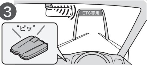
そのまま進むとETC車載器と路側アンテナ間で、必要な情報が通信されます。
