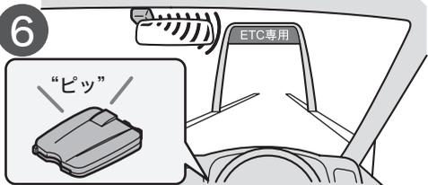
ETC車載器と路側アンテナ間で、精算に必要な情報が通信されます。
