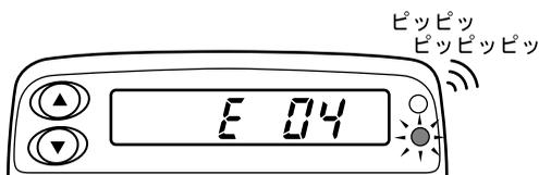
ETC車載器に異常が発生した場合は、表示部に「E 04」と表示され赤色ランプが点灯しブザー音が「ピッ、ピッ、ピッ、ピッ、ピッ」と5回鳴ります。
