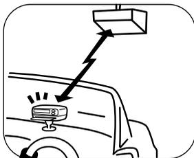
そのまま進むと、ETC車載器と路側無線装置で通信を行います。ETC車載器からは、車両情報などが送信されます。
