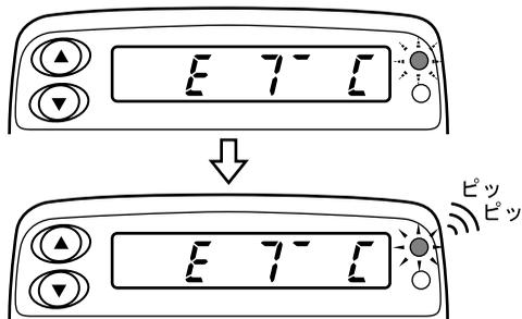
ETC車載器の緑色ランプが点滅しブザー音が「ピッ、ピッ」と2回鳴ります。緑色ランプは点滅が終了すると点灯状態にもどります。
