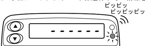
ETC車載器の赤色ランプが点灯し、表示部に「-----」の表示がされブザー音が「ピッ、ピッ、ピッ、ピッ、ピッ」と5回鳴ります。
