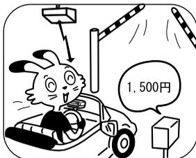
ETC車載器と路側無線装置間で、入口料金所情報や車両情報など料金精算に必要な情報が通信されると、瞬時に料金が計算され発進制御装置(ゲート)が開き通行できます。また、利用履歴がETCカードに書き込まれます。
