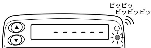
(2) ETC車載器の赤色ランプが点灯し表示部に「-----」「E 06」もしくは「E 07」の表示がされブザー音が「ピッ、ピッ、ピッ、ピッ、ピッ」と5回鳴ることがあります。
