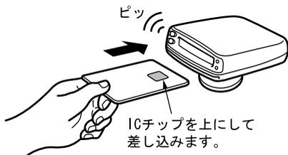
(3) ETCカードをETC車載器に挿入方向を確認し、ブザー音が「ピッ」と1回鳴るまでしっかり差し込みます。
