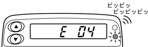
ETC車載器に異常が発生した場合は、表示部に「E 04」と表示され赤色ランプが点灯しブザー音が「ピッ、ピッ、ピッ、ピッ、ピッ」と5回鳴ります。
