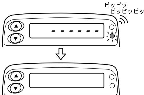
ETC車載器の赤色ランプが点灯し、表示部に「-----」の表示がされブザー音が「ピッ、ピッ、ピッ、ピッ、ピッ」と5回鳴ります。表示は16秒間表示され、その後全表示部が消灯します。
