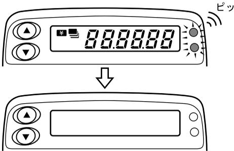
(2) ETC車載器の全表示部が2秒間表示しブザー音が「ピッ」と1回鳴った2秒後に、全表示部が消灯します。
