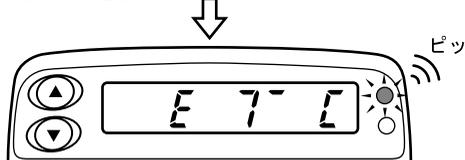
(4) ETCカードの認証中は表示部が順次点灯し緑色ランプが点滅します。認証の終了後は表示部に「ETC」と表示されて、緑色ランプが点灯し、ブザー音が「ピッ」と1回鳴ります。
