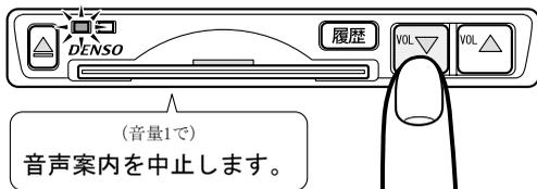
音量を0（無音）に切り替えると、音量1（最小音量）で「音声案内を中止します。」と音声案内し、以降は音量を1以上にするまで音声案内は行われません。
