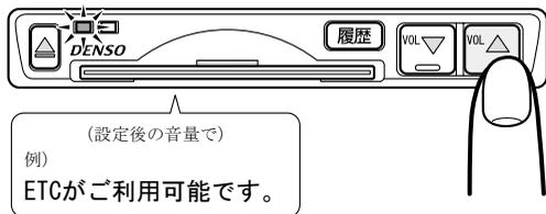
ETC車載器前面の音量 UP スイッチを押すごとに音声案内を中断して音量が 1 段階ずつ大きくなり、設定後の音量で案内していた内容を再び音声案内します。
