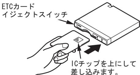
3 ETCカードをETC車載器に挿入方向を確認し、ETCカードイジェクトスイッチが突出するまでしっかり差し込みます。
