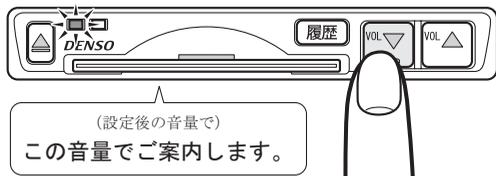
ETC車載器前面の音量DOWNスイッチを押すごとに音量が1段階づつ小さくなり、設定後の音量で「この音量でご案内します。」と音声案内します。
