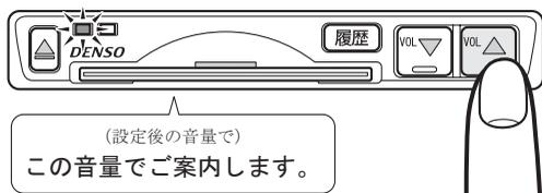
ETC車載器前面の音量UPスイッチを押すごとに音量が1段階づつ大きくなり、設定後の音量で「この音量でご案内します。」と音声案内します。
