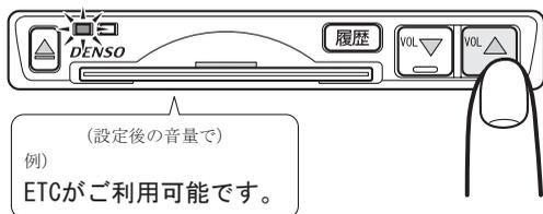
ETC車載器前面の音量UPスイッチを押すごとに音声案内を中断して音量が1段階づつ大きくなり、設定後の音量で案内していた内容を再び音声案内します。
