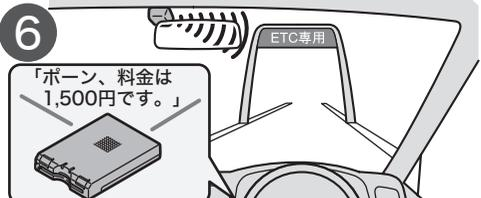
ETC車載器と路側アンテナ間で、精算に必要な情報が通信されます。
