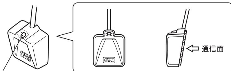
ETCカード挿入確認ランプ<緑> 通信面(ガラス貼り付け面<一部車種を除く>) ETCカードが挿入されるときの点灯します。 路側アンテナとの通信を行うETC車載器側のアンテナです。
