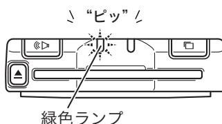
4. ETC カードの確認が終了すると緑色ランプが点灯し、ブザー音が“ポーン”と鳴り、「ETC カードが挿入されました。」と音声案内します。また、アンテナの ETC カード挿入確認ランプ<く緑>が点灯します。
