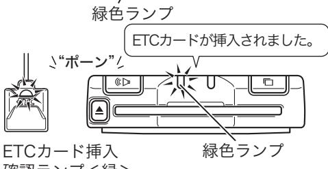
4. 【利用履歴確認スイッチ】を押すと緑色ランプが点滅し、最新の利用履歴を音声案内します。
