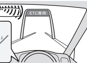
ETC車載器と路側アンテナ間で、精算に必要な情報が通信されます。
