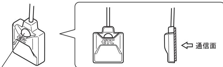
ETCカード挿入確認ランプ<緑> 通信面(ガラス貼り付け面<一部車種を除く>)
