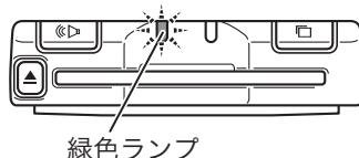
4. ETC カードの確認が終了すると緑色ランプが点灯し、ブザー音が“ポーン”と鳴り、「ETC カードが挿入されました。有効期限は○○○○年○○月です。」と音声案内します。また、アンテナの ETC カード挿入確認ランプ＜緑＞が点灯します。
