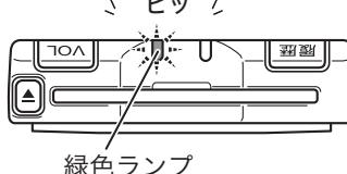
4. ETC カードの確認が終了すると緑色ランプが点灯し、ブザー音が“ポン”と鳴り、「ETC カードが挿入されました。有効期限は○○○○年○○月です。」と音声案内します。また、アンテナの ETC カード挿入確認ランプ＜緑＞が点灯します。
