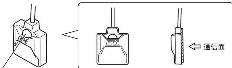
ETCカード挿入確認ランプ<緑> 通信面(ガラス貼り付け面<一部車種を除く>) 路側アンテナとの通信を行うETC車載器側のアンテナです。
