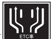
料金所の入口と同様に、ETC車線表示板にしたがって料金所の出口にゆっくり進みます。(時速20km/h以下で安全に)
