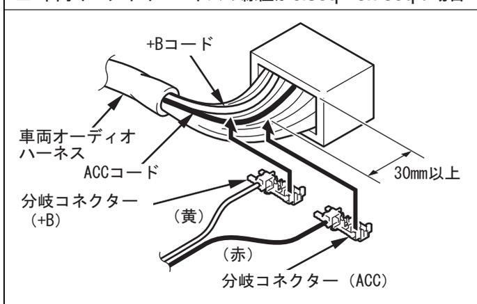
(2) 電源ハーネスの分岐コネクタを接続先の車両オーディオハーネスの+B、ACCコードに接続する。
