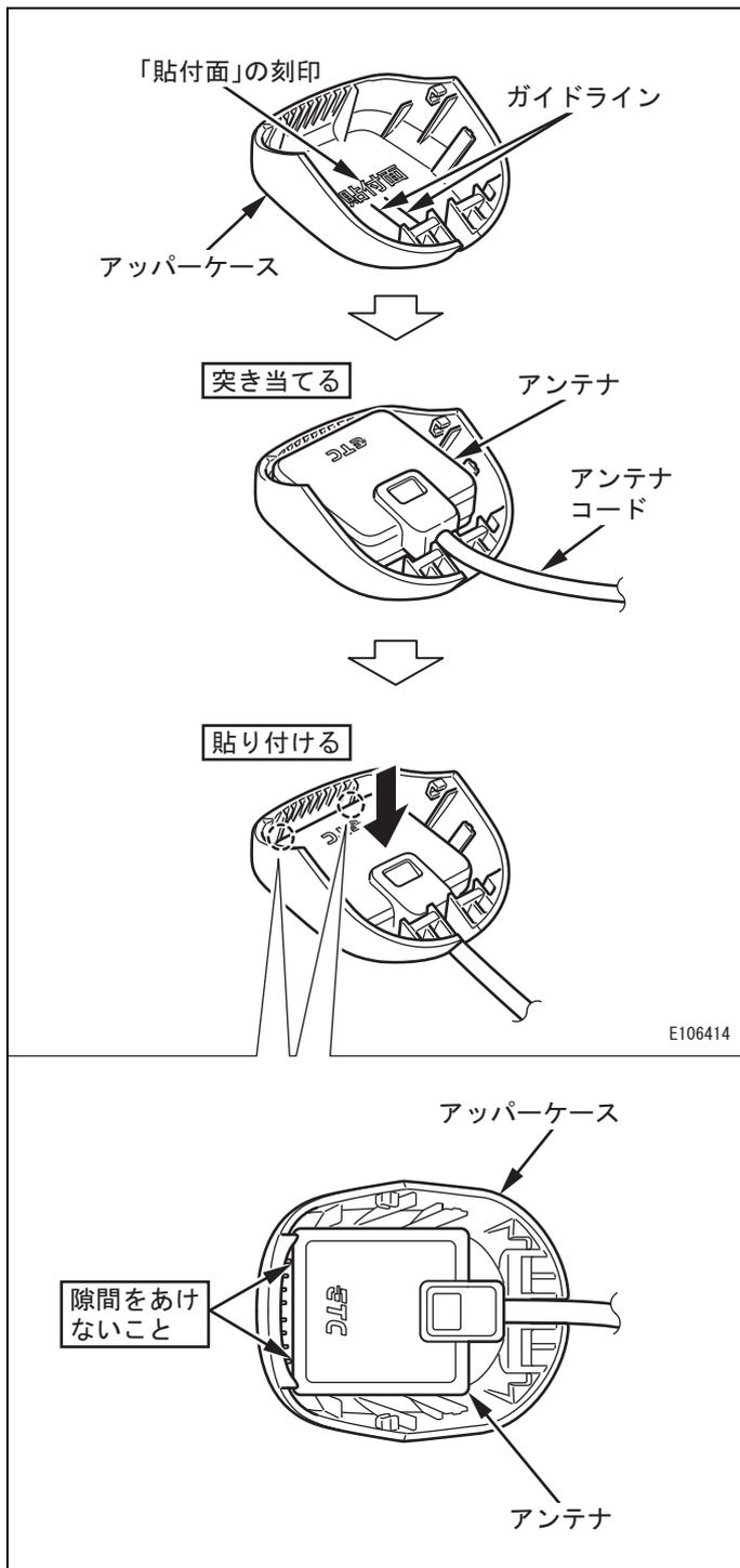
(2) アンテナをアップパーケース内側の貼付面と平行にして差し込み、アップパーケース後方に突き当てる。
