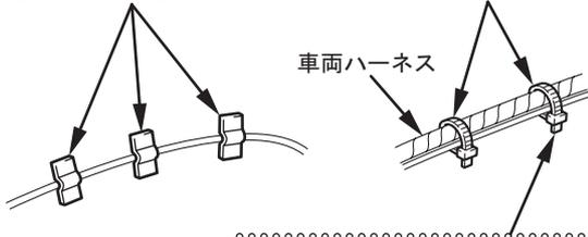
バンドクランプは締め付け後、余った先端部を切り取ってください
