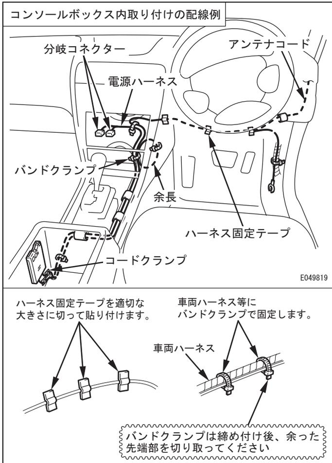
■ ETC 車載器をコンソールボックス内へ取り付ける場合
