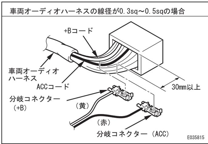
(4) 電源ハーネスの分岐コネクタを接続先の車両オーディオハーネスの +B、ACC ハーネスに接続する。
