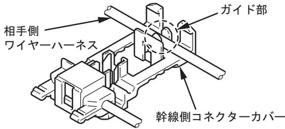
2. コネクタ本体のヒンジ中心部を支点にして、幹線側コネクタカバーを折り返します。
