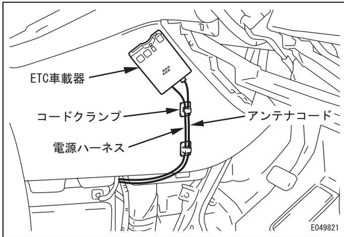
(2) アンテナコードおよび電源ハーネスをコードクランプを使用して固定する。
