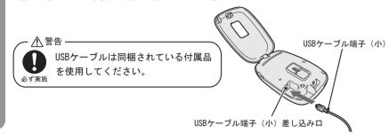
USBケーブルを背面カバーのUSBケーブル通し溝に通して、 背面カバーを固定してください
