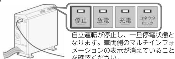
※「復電時放電継続機能」設定をOFFにしている場合、復電後に運転が自動停止するため、この操作は不要です。
