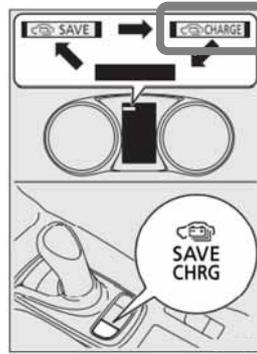
マルチインフォメーションディスプレイ上部のバッテリーチャージモードランプが点灯し、割り込み表示が表示されます。満充電近くなると充電は停止し、割り込み表示が消えます。
