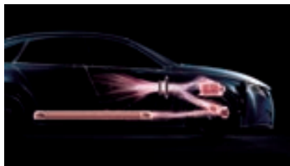
排熱を効率的に利用することで、エアコンの消費電力を抑えます。
