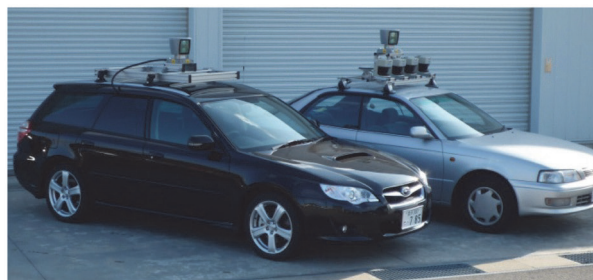
Fig. 3 著者らの研究室で開発した自動運転自動車
