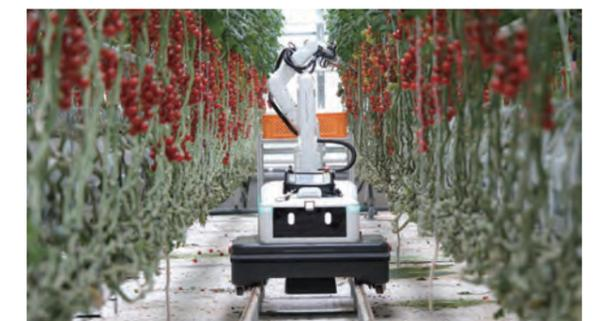
Fig. 1 アグリッドではたらくトマト自動収穫ロボット
