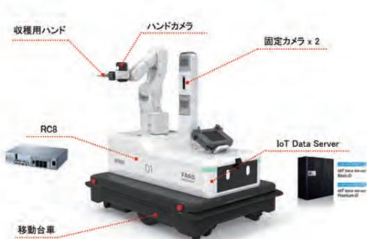
Fig. 2 トマト自動収穫ロボット構成図
